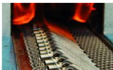
Lötprozess im Durchlaufflöten
